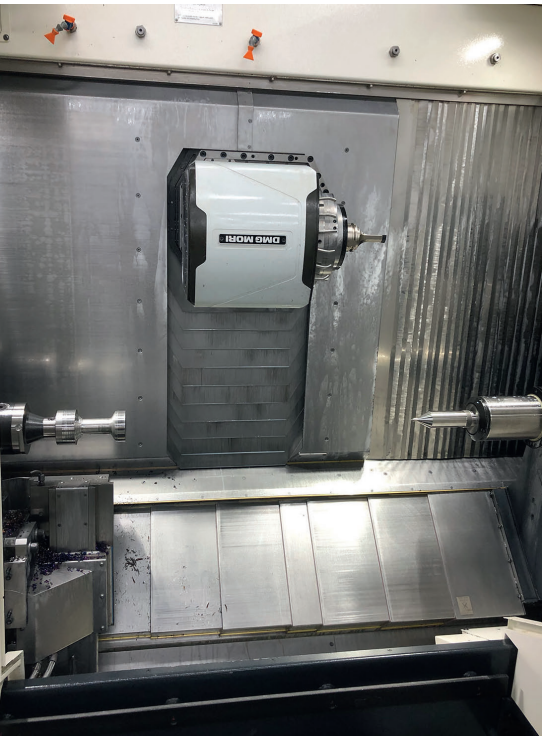
2 Die Technologie läuft auf einer drehfräs-geeigneten Maschine DMG Mori CTX beta 1250 TC mit einer Steuerung Siemens Sinumerik 840 D © Ceratizit
